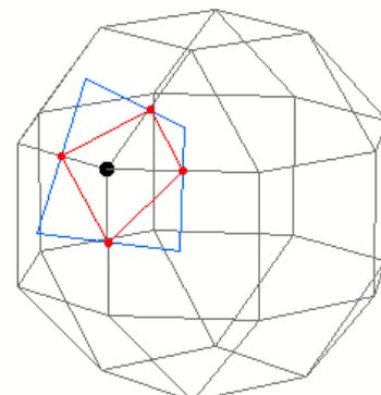
Wenn das erste Deltoid zusammengesetzt ist, ist dann etwas räumliche Vorstellungskraft nützlich. Die Symmetrien der Figur werden eingesetzt und weitere Deltoide durch Drehung um die z-Achse erzeugt und auch gleich gezeichnet
