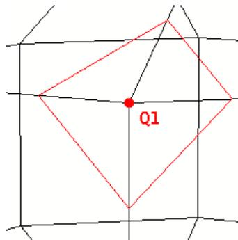
Die Seitenlängen werden berechnet und ergeben sich mit  $a\sqrt{2}/2$ ,  $a\sqrt{2}/2$ ,  $a\sqrt{2}/2$  und  $a/2$ . Dabei ist  $a$  noch immer die Kantenlänge des ursprünglichen Rhkos. Alle Zeichnungen werden mit  $a = 3$  ausgeführt. Der Zusammenhang Trapez-Deltoid wird vorerst in der Ebene studiert. Die gewonnenen Maße sollen dann in die räumliche Figur übernommen werden.
