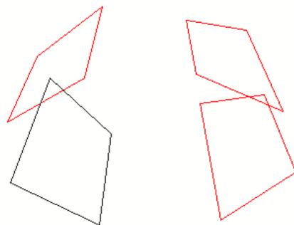
Da die Oberfläche aus zwei Scharen von unterschiedlich orientierten Deltoiden besteht, muss man jeweils Deltoide herausfinden, die rotiert, die Figur schrittweise zusammenbauen. Das ist ein wenig Tüftelei, lässt sich aber mit der simultanen Kontrolle im Zeichenfenster gut bewältigen. Die zweite Familie von Deltoiden schließt den angefangenen Kranz.
