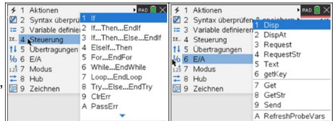
Das *Menü 6:E/A* enthält alle Befehle zur Kommunikation mit dem Nutzer (Anzeigebefehle, Eingabebefehle)
