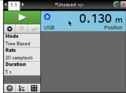
In der DataQuest™-Applikation können abhängig vom Sensor die Einstellungen verändert werden. Um das Einstellungsfenster zu öffnen, muss der einzustellende Sensor in der Messansicht angeklickt werden.
