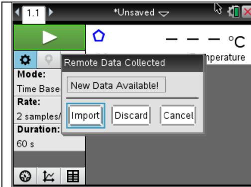
Nach Ablauf der Messzeit wird das Lab Cradle wieder angeschlossen. Durch Drücken der **Import**-Schaltfläche werden die Daten übertragen und können in den verschiedenen Formen (Graph, Tabelle) dargestellt werden.
