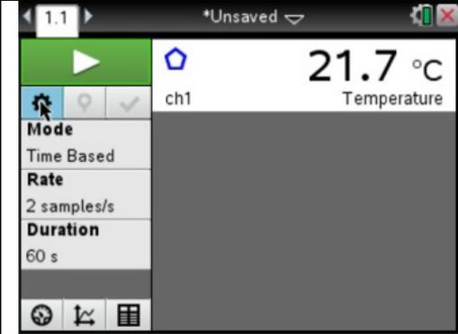
Nach dem Start der Applikation DataQuest™ und dem Anschließen des Sensors wird automatisch der aktuelle Messwert angezeigt. Der Messmodus und die voreingestellten Messparameter können verändert werden.
