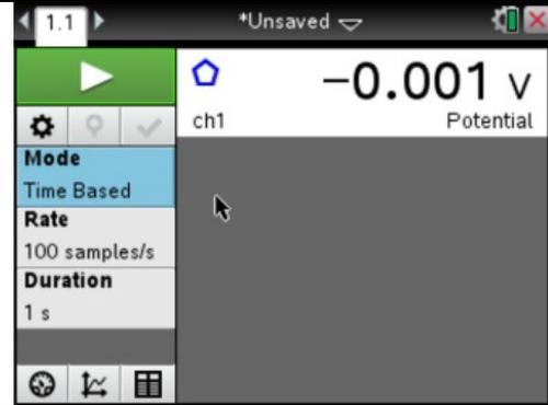
Das Lab Cradle wird mit dem Handheld oder PC verbunden. Es muss mindestens ein Sensor angeschlossen sein. Zunächst sind Abfrage-rate und Messzeit (Anleitung 2) einzustellen.
