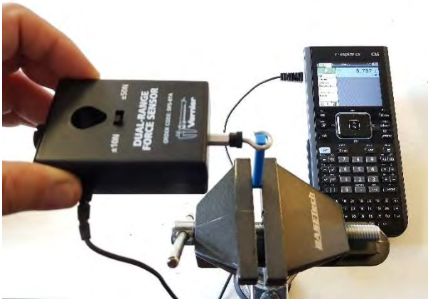
Abbildung 109: Freihandexperiment: Der zu untersuchende 3D-Druck ist im Schraubstock eingespannt - hier wird bereits mit einer Kraft von 6.7 N gezogen
