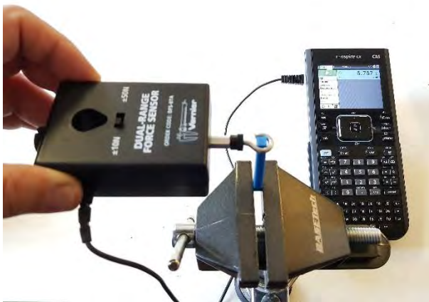
Abbildung 112: Freihandexperiment: Der zu untersuchende 3D-Druck ist im Schraubstock eingespannt – hier wird bereits mit einer Kraft von 6.7 N gezogen
