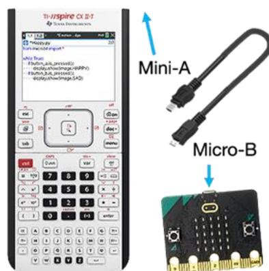
Abbildung 11: Mini-zu-Micro-USB-Kabel
